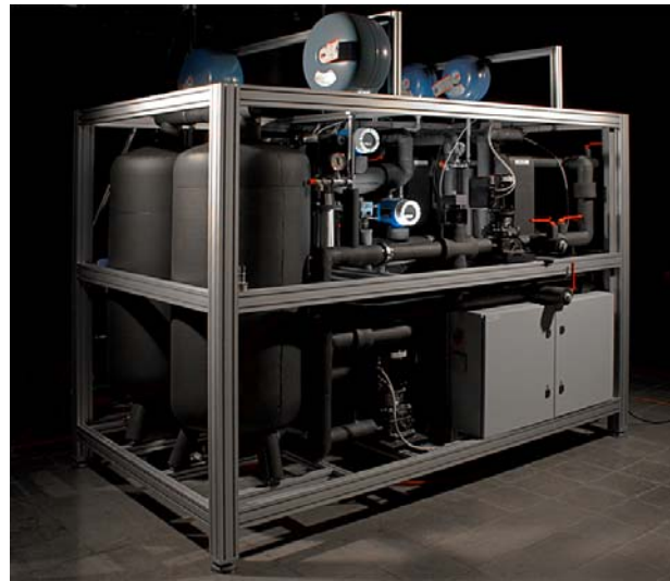
Abb. 4: Wärmemodul zur Simulation der Wärmequelle und Wärmesenke von Wärmepumpen und Klimakälteanlagen
