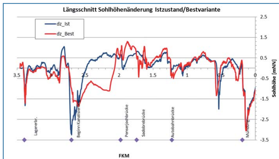
Bild 6. Sohlhöhenänderung Bestvariante (Best)/Ist-Zustand (Ist) nach einem HQ100.
