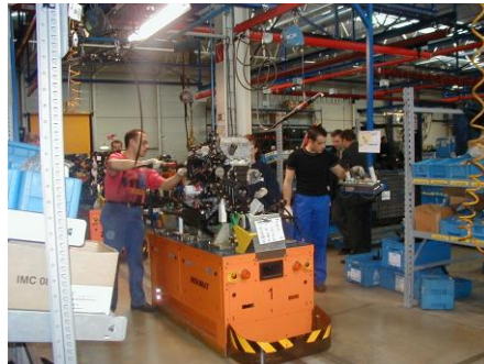
Abbildung 4: FTF als Montage-Plattform 5
